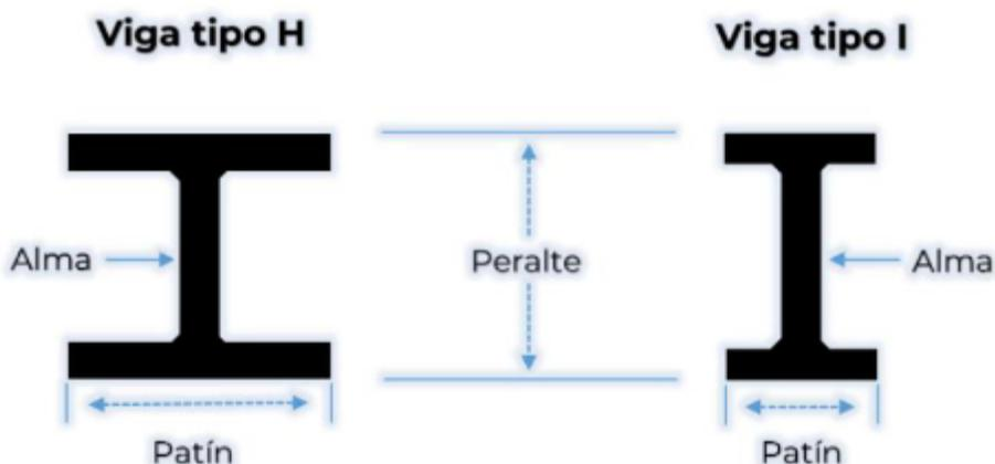
7. El producto objeto de investigación se describe por sus dimensiones, entre las que se encuentran: el peralte (altura), ancho del patín, espesor del patín y espesor del alma, así como por las propiedades físicas y la composición química de los aceros con los que se fabrican. En su fabricación se utilizan cinco tipos de aceros conjuntados en dos grupos: i) acero A36, y ii) aceros A529-
